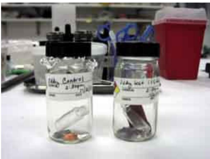
Figura 16 – Exemplo de *Test Oddy* para determinar se o material vai liberar sulfetos voláteis ou ácidos
