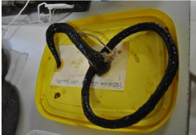
Figura 41 – Gancho com argola no tratamento com ácido tânico
