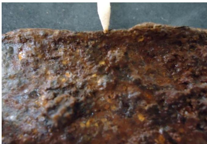
Figura 46 – Aparecimento das gotículas de corrosão ativa
