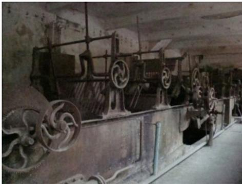
Figura – 49. Máquina de pentear lã (localizada no prédio da antiga charqueada de Bagé). Fonte: acervo do autor, 2013.
