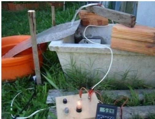
Figura – 21. Processo de gravação com corrente d'água submetido às variações do clima (vento, chuva, folhas...). Fonte: acervo do autor, 2012
