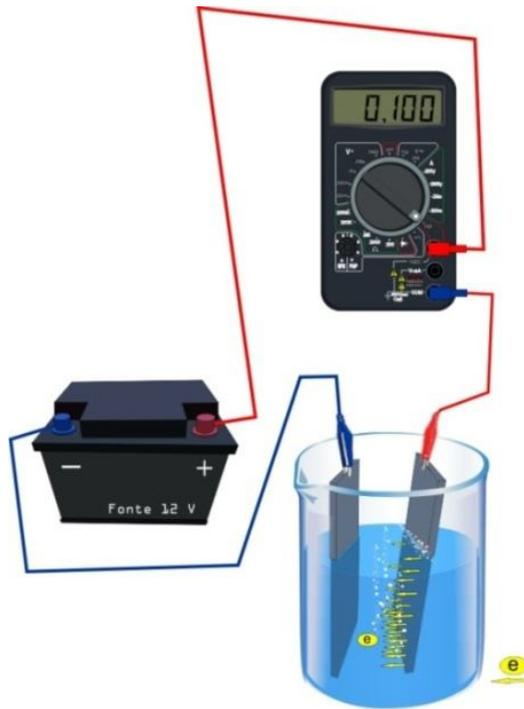
Figura – 2. *Eletrólise com placas submersas.* Fonte: acervo do autor, 2012.
