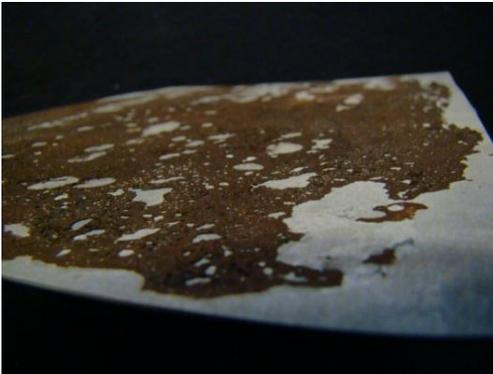
Figura – 41. Matriz de alumínio com o resíduo do cubo de ferro fixado sobre a superfície do metal. Fonte: acervo do autor, 2013
