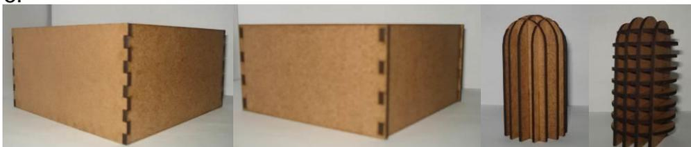
Figura 5 – Encaixe **borda/aresta em todo o perímetro, perpendicular em todo perímetro, seriado com encaixe vertical** e **seriado com encaixe vertical-horizontal**. Fonte: Autora
