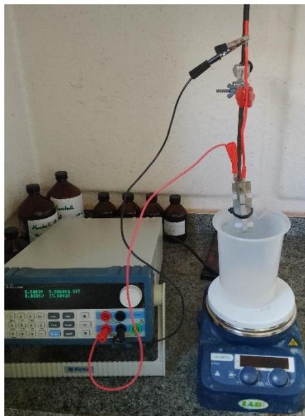
Figura 29 - Estação de trabalho para a realização de ataque eletroquímico com  $\text{HBF}_4$  diluído.
