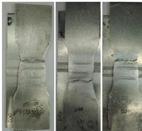
Figura 67 - Corpos de prova das juntas dissimilares após ensaio de tração.
