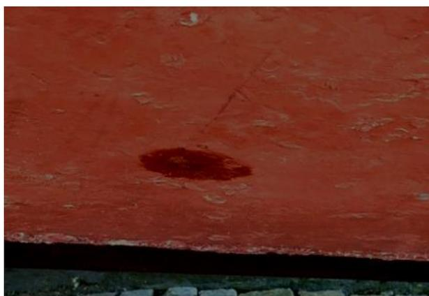
Figura 3 - Ponto de infiltração observado nas obras vivas do casco da LAEP, devido à corrosão por pite.
