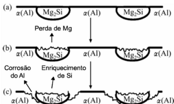
Figura 19 - Mecanismo simplificado da corrosão da fase  $\text{Mg}_2\text{Si}$ .
