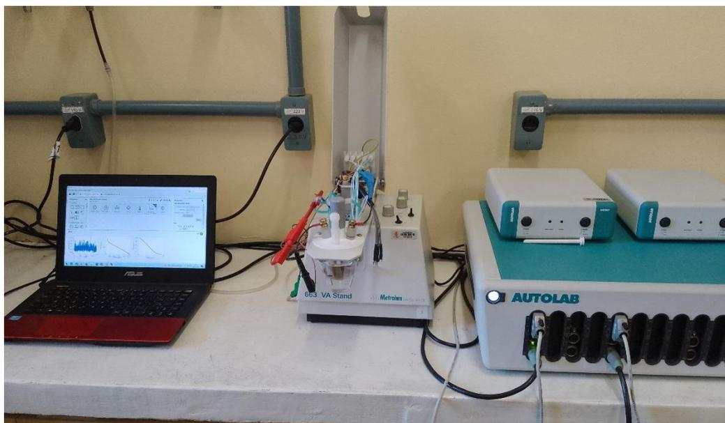
Figura 32 - Arranjo dos equipamentos utilizados durante os ensaios de polarização potenciodinâmica.
