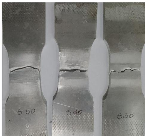
Figura 69 - Corpos de prova das juntas similares após ensaio de tração.
