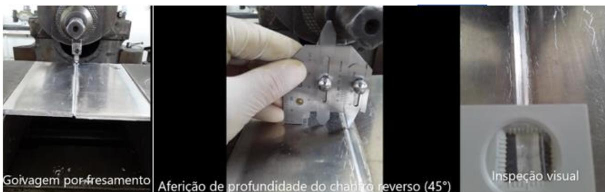
Figura 26 - Procedimento de goivagem mecanizada em plaina mecânica. Aferição da profundidade do chanfro ao logo da peça e inspeção visual através de lupa de escala.
