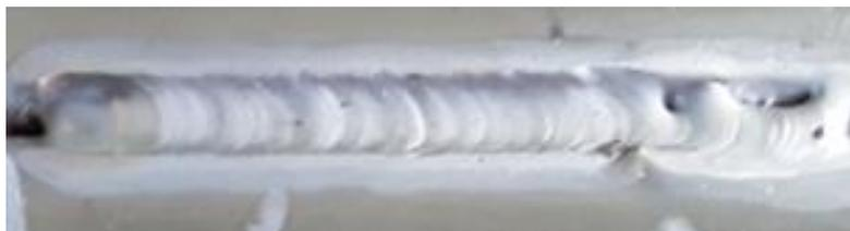
Figura 27 - Defeito de falta de deposição de metal de adição no começo do cordão, em função da movimentação da tocha e alimentação do arame iniciar a partir da abertura do arco não aguardando formação completa da poça de fusão.
