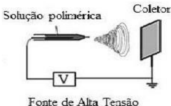
Figura 2: Representação esquemática do processo de electrospinning
