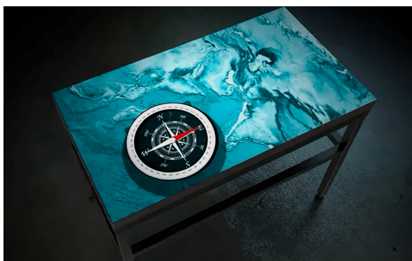
Figura 40 – Mesa multitouch que reconhece objetos Fonte: Multitacion [S.d.]
