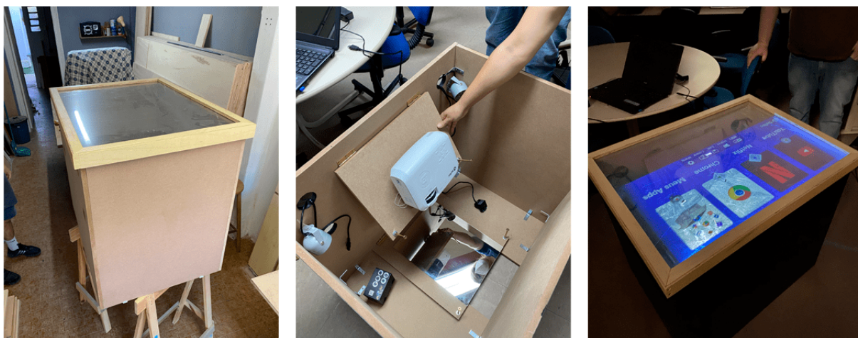
Figura 8 – Processo de construção de mesa tangível. Fonte: Autor (2020)
