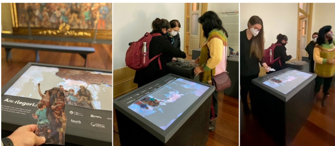
Figura 50 – Detalhe dos tokens (à esquerda) e usuários manipulando-os com a mesa tangível (à direita). Fonte: Autor (2022)
