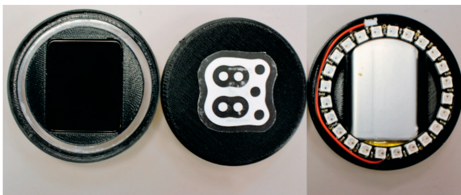
Figura 13 – Token que conjuga sensores embarcados no smartwatch com o reconhecimento por visão computacional e sensores para feedback em leds. Fonte:(ARIF et al., 2016)
