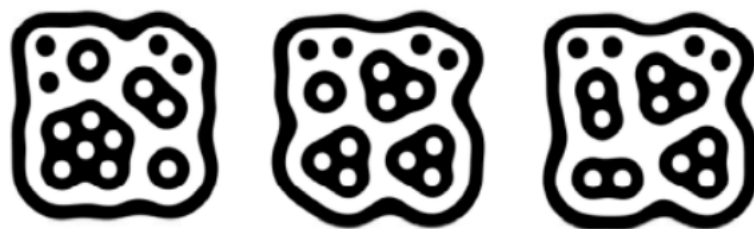
Figura 34 – Marcadores fiduciais padrões do reacTIVision. Fonte: Kaltenbrunner; Bencina (2007)
