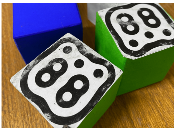
Figura 67 – Desgaste apresentado pelo fiducial anexado ao token gerado pela manipulação desse sobre a mesa. Fonte: Autor (2023)
