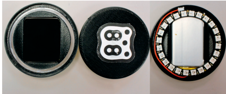
Figura 25 – Token que conjuga sensores embarcados no smartwatch com o reconhecimento por visão computacional e sensores para feedback em leds. Fonte: Arif et al. (2016)
