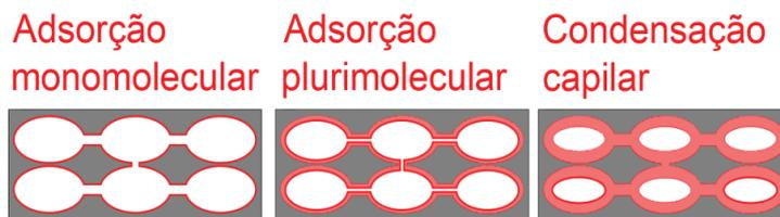
Figura 3. Ilustração do fenômeno da higroscopicidade.
