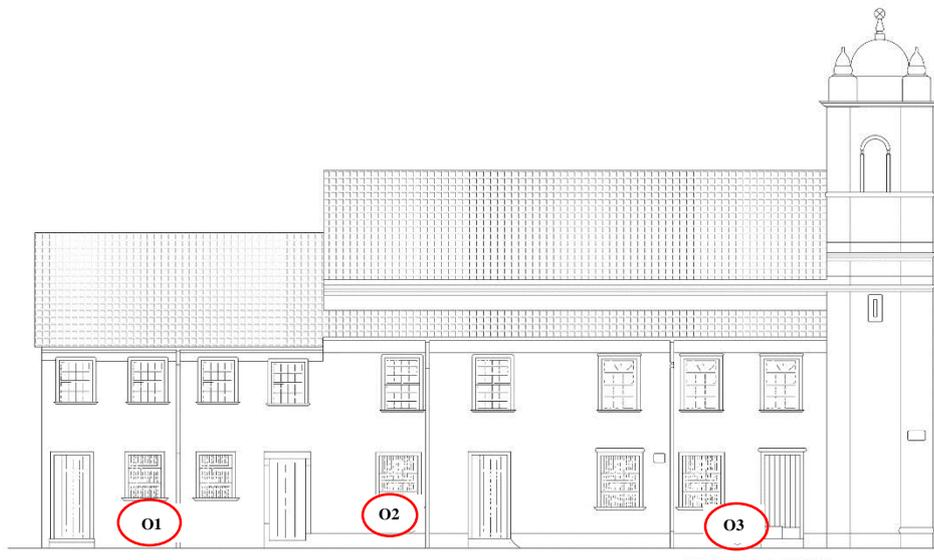
Figura 217. Pontos críticos de umidade identificados na fachada oeste da Catedral.
