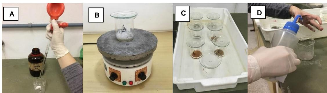
Figura 242. Ensaio para determinação de cloretos totais. (A) Adição de ácido nítrico nas amostras; (B) Fervura da solução argamassa - ácido nítrico; (C) Resfriamento da solução fervida; (D) lavagem da parte inferior do vidro relógio e do Becker com água destilada.
