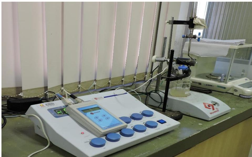
Figura 264. Potenciômetro utilizado para a determinação dos cloretos totais.
