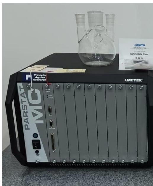
Figura 11. Potenciostato Ametek
