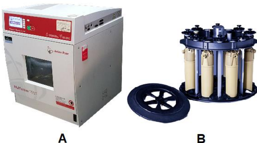
Figura 3. (A) Forno micro-ondas e (B) rotor para oito frascos, utilizados no preparo de amostras.
