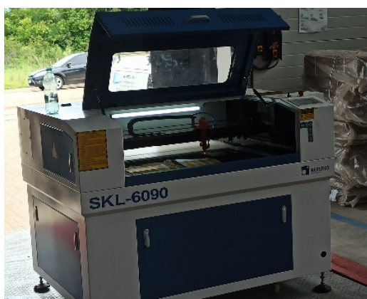
Figura 33- Laser de CO 2 de 100W disponible en UTEC Fuente: Imagen propia
