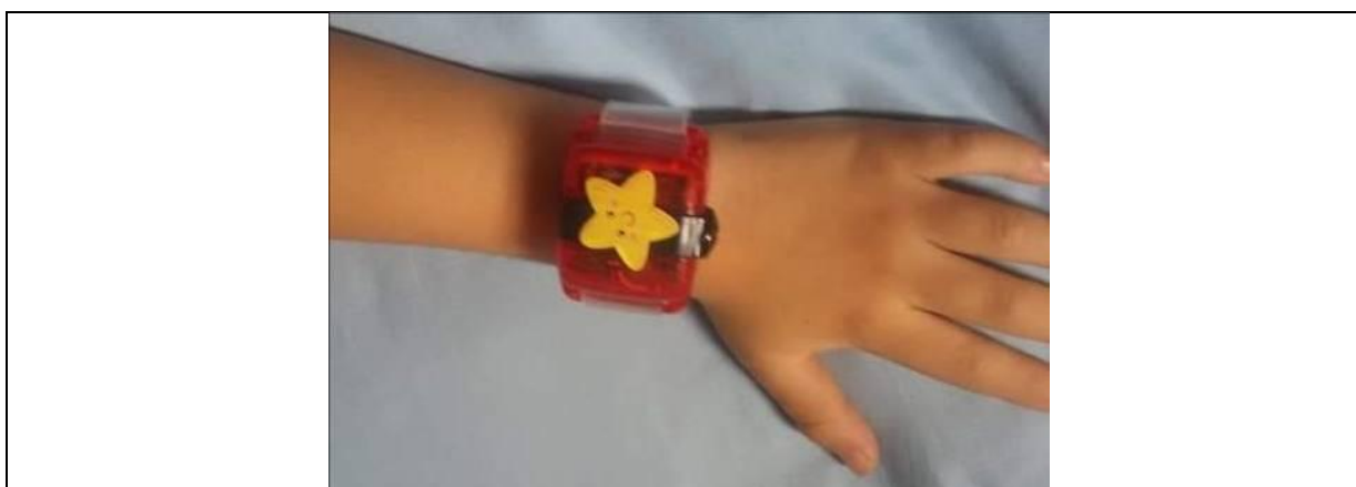
Figura 3 - Posição correta do acelerômetro para fixação ao pulso.
