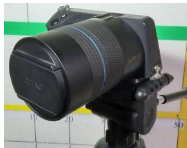
Figura 33 – Câmera Lytro Illum usada nos experimentos e na construção do dataset . Fonte: De autoria própria.
