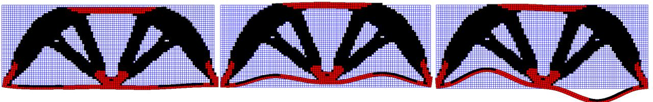
Figura 20: Estrutura otimizada do caso 2, com material piezolétrico, com o 1º, 2º e 3º modos de vibração, respectivamente.
