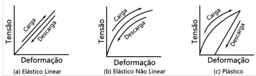
Figura 5: Curvas de tensão-deformação para diferentes materiais. Fonte: Adaptado de MASE; SMELSER; MASE (2010).
