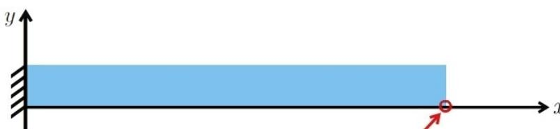
Figura 15: Viga engastada de um lado.
