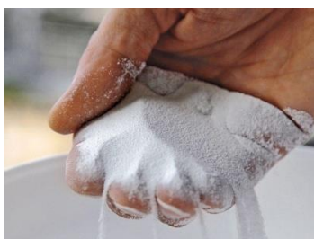
Figura 3 – Exemplo de PCM micro encapsulado.
