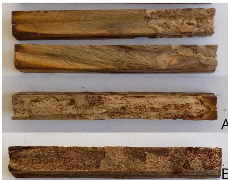
Figura 16 - Amostras não expostos ao envelhecimento e deterioradas pelos cupins, sendo que controle (A) e PAS (B).
