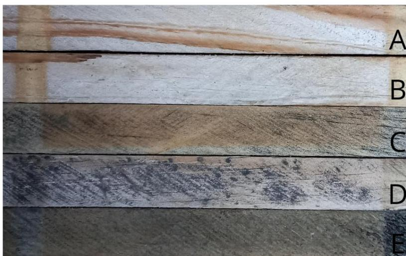
Figura 64 - Corpos de prova após a exposição ao envelhecimento acelerado, sendo controle (A), PAS (B), CuO (C), ZnO (D) e CuO/ZnO (E).
