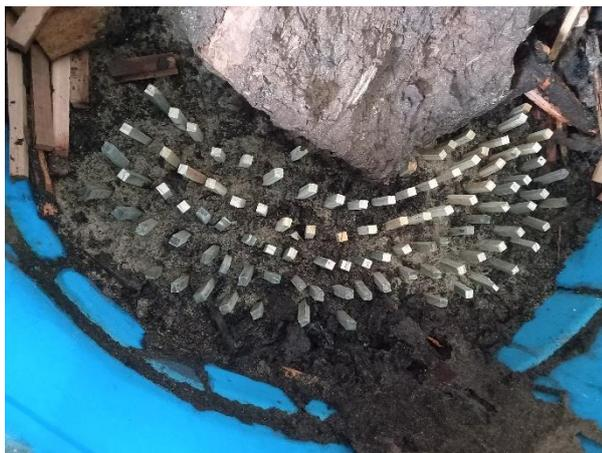
Figura 1 - Imagem da caixa de fibra contendo o cupinzeiro e os corpos de prova dispostos em linhas.
