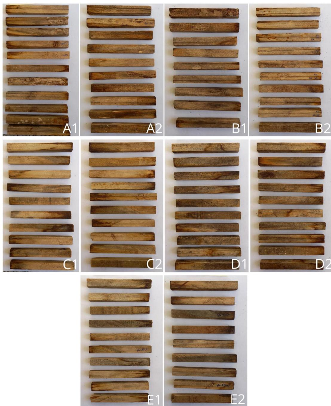
Figura 15 - Corpos de prova após exposição a biodeterioração por cupins, sendo controle (A), PAS (B), CuO (C), ZnO (D) e CuO/ZnO (E), não envelhecidos (1) e envelhecidos (2).
