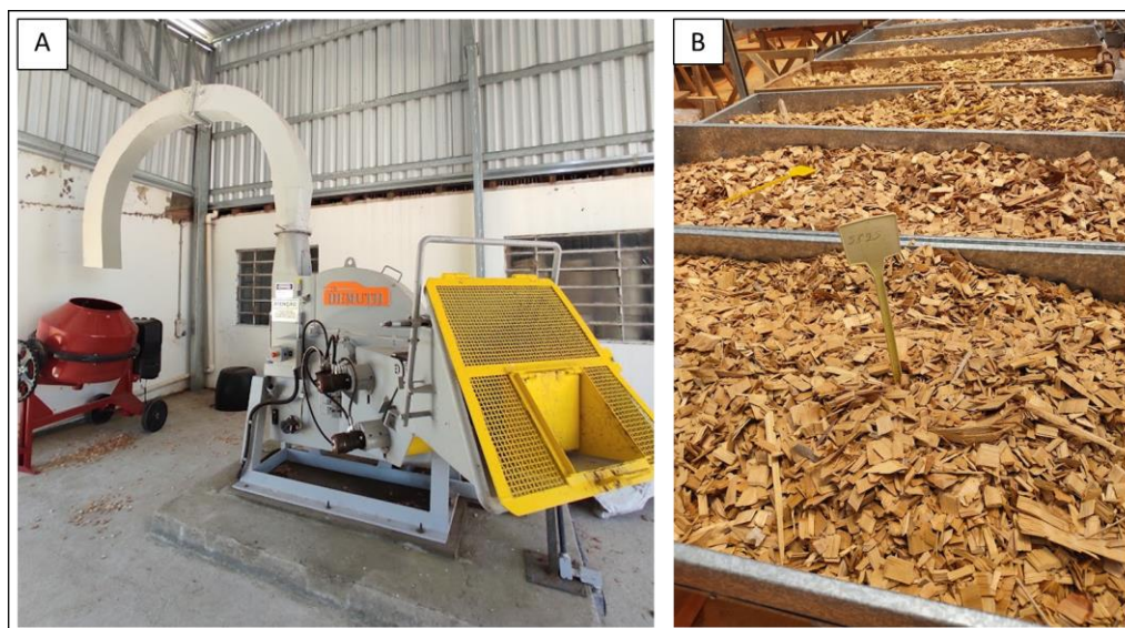
Figura 6 - Processo de picagem. A) Picador de cavacos; B) Secagem de cavacos.
