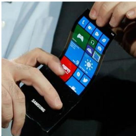
Figura 5: Protótipo de tela flexível proposta pela Samsung em 2013.
