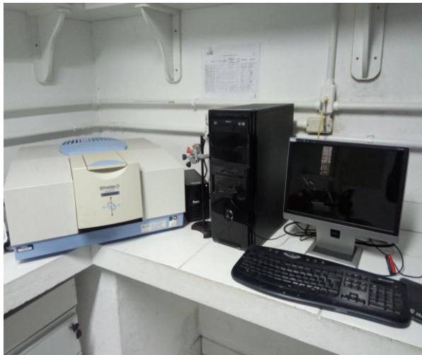
Figura 9. Espectroscopia no infravermelho com transformada de Fourier, Faculdade de Odontologia.
