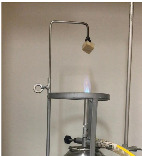
Figura 13. Demonstração de como foi realizado o teste de chamas criado pela doutoranda de engenharia de materiais Vanessa Dummer, Departamento de Engenharia Industrial Madeireira.
