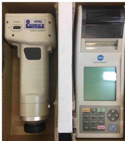
Figura 10. Colorímetro Konica Minolta, Departamento de Engenharia Industrial Madeireira.
