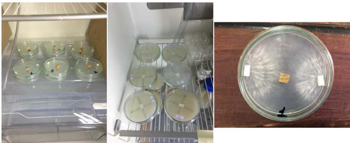
Figura 11. Ensaio realizado para verificar a eficiência do \text{TiO}_2 e do processo de modificação quanto ao ataque de fungos apodrecedores, Departamento de Engenharia Industrial Madeireira.
