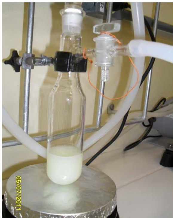
Figura 7: Reação de síntese sol-gel ao final do processo, das reações “B e D”.
