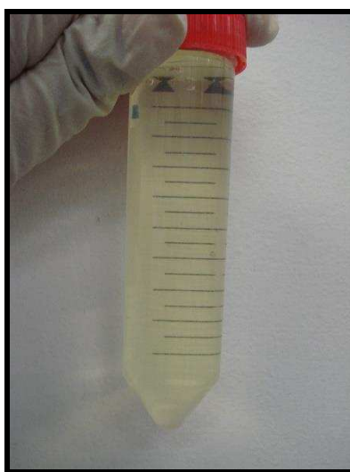
Figura 40 - Amostra de erva-mate após decomposição em sistema fechado assistido por radiação micro-ondas.
