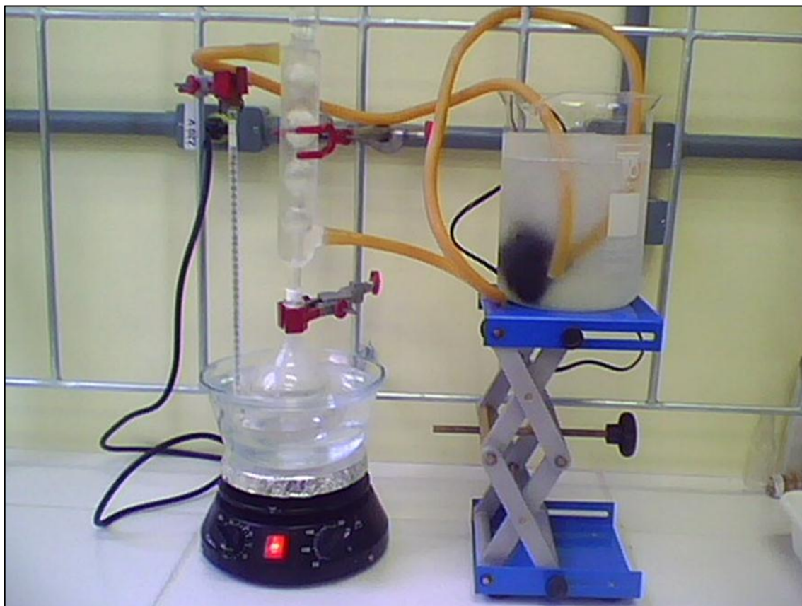
Figura 19. Arranjo experimental para síntese das nanopartículas de ouro. Fonte: DA SILVA, p.41.
