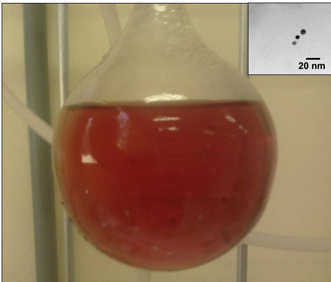
Figura 20. Solução coloidal das nanopartículas de ouro sintetizadas. Em detalhe: Imagem de Microscopia Eletrônica de Transmissão das nanopartículas de ouro formadas. Fonte: DA SILVA, p.41.
