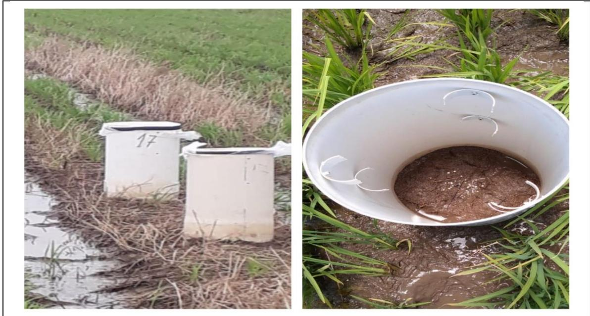
Figura 10: Coletores de PVC para determinar as perdas de amônia volatilizada
