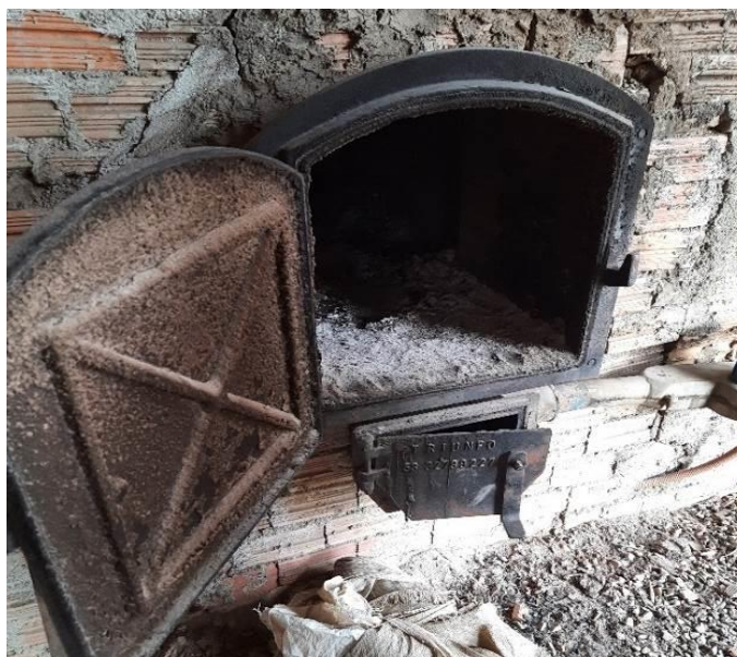
Figura 23 – Fotografia da porta de alimentação da estufa. Fonte: Fotografado pela autora.
