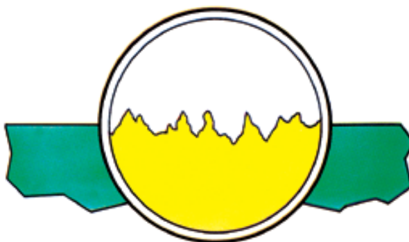
Figura 7: Superfície metálica ampliada 20.000 vezes.
