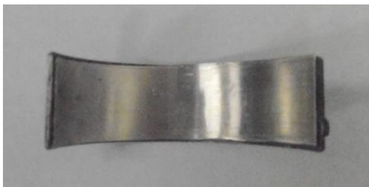
Figura 20: Aspecto da superfície do casquilho prata após 8000km rodados.
