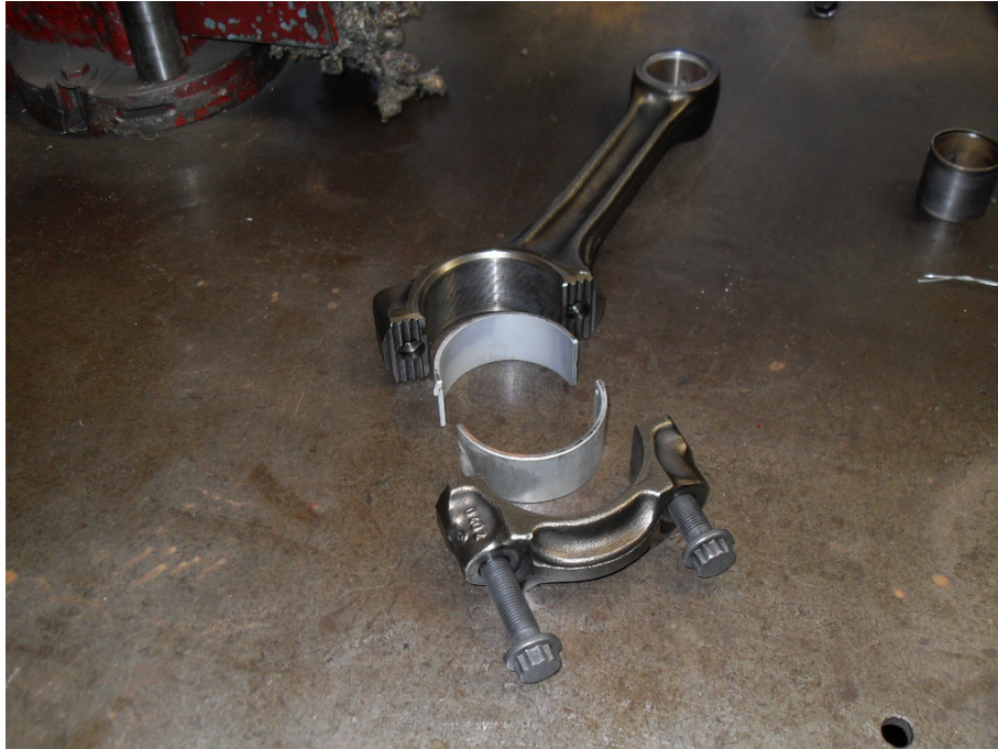
Figura 3: Casquilhos sendo colocados em biela.
