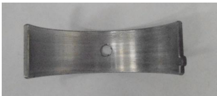
Figura 21: Aspecto da superfície do casquilho original após 8000 km rodados.
