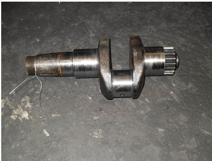
Figura 2: Virabrequim de motor Agrale 12.
