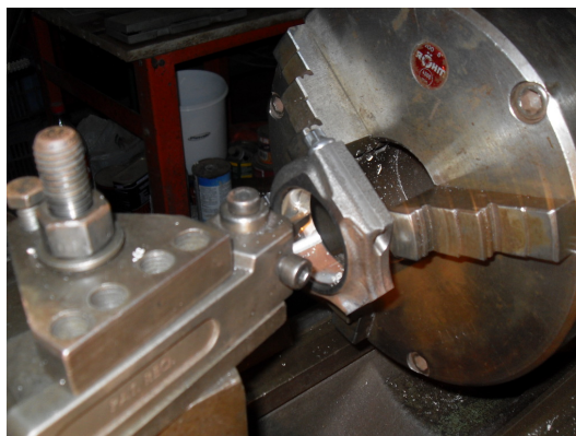
Figura 13: Torneamento objetivando as medidas recomendadas pela GM do Brasil para utilização em um motor 1.0 VHC flex power standard.
