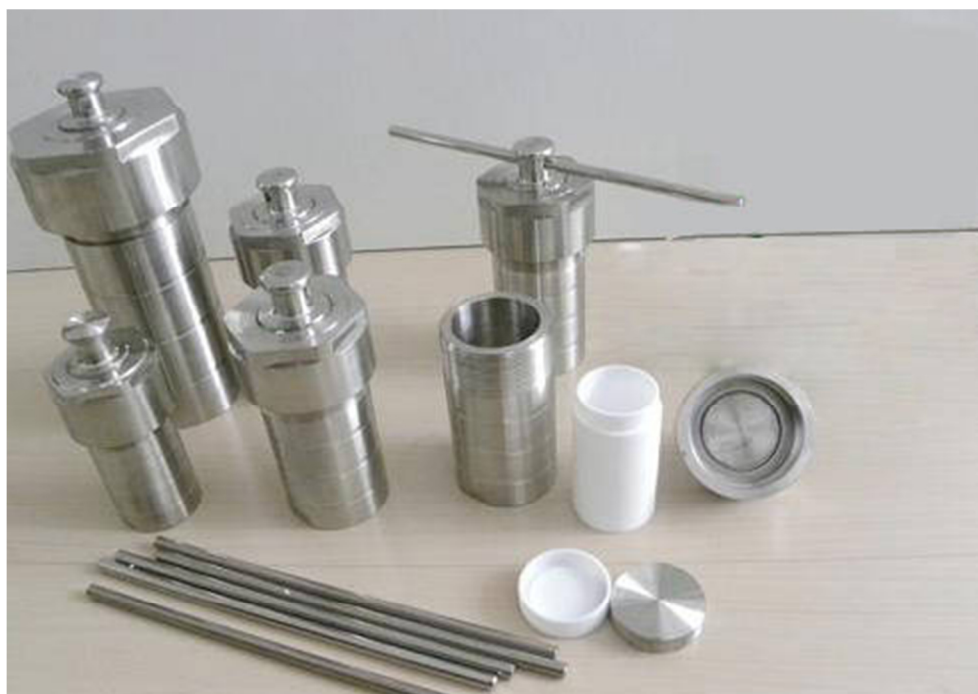
Figura 3. Autoclaves com várias capacidades volumétricas tipicamente utilizadas para sínteses hidrotérmicas com fontes de aquecimento convencionais.
