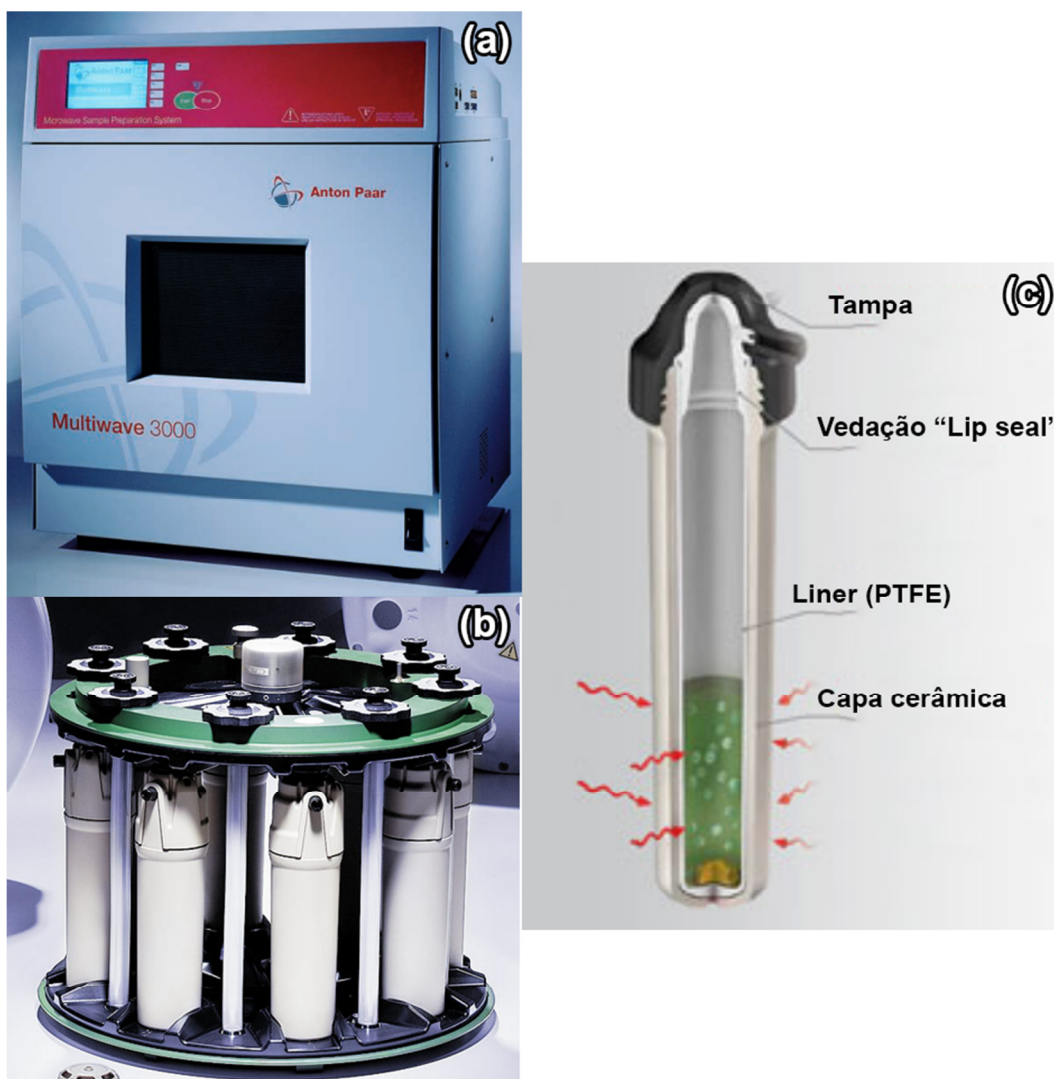
Figura 4. Forno micro-ondas Multiwave 3000 da Anton Paar (a), rotor de suporte dos reatores (autoclaves) (b) e detalhe construtivo do reator (c).
