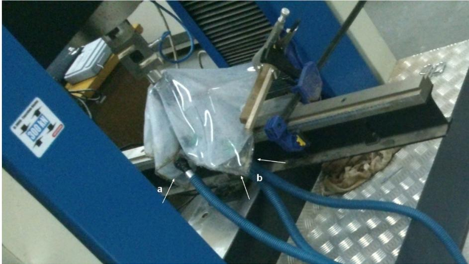
**Figura 9** – Invólucro para manutenção das condições de tratamento para a flexão estática, em que: a=entrada de vapor d'água; b=saídas de vapor d'água.
