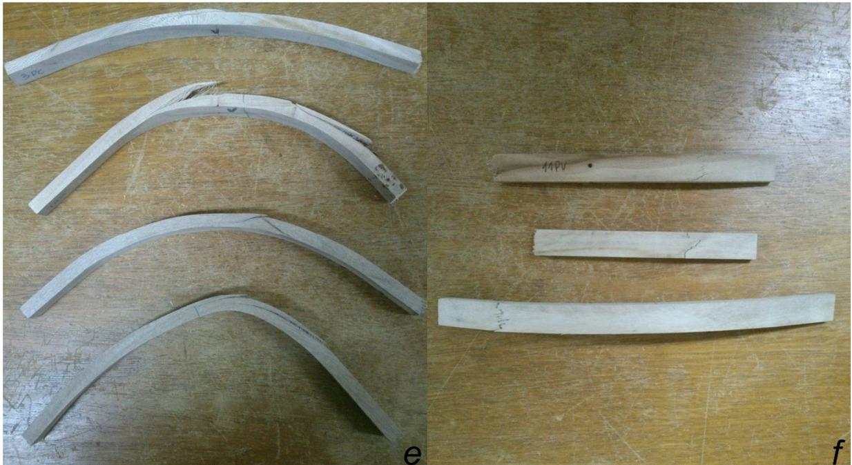
**Figura 15** – Corpos de prova vergados com incidência de defeitos do tipo *e* (estilhaço) e *f* (ruptura perpendicular). Fonte: O autor.
