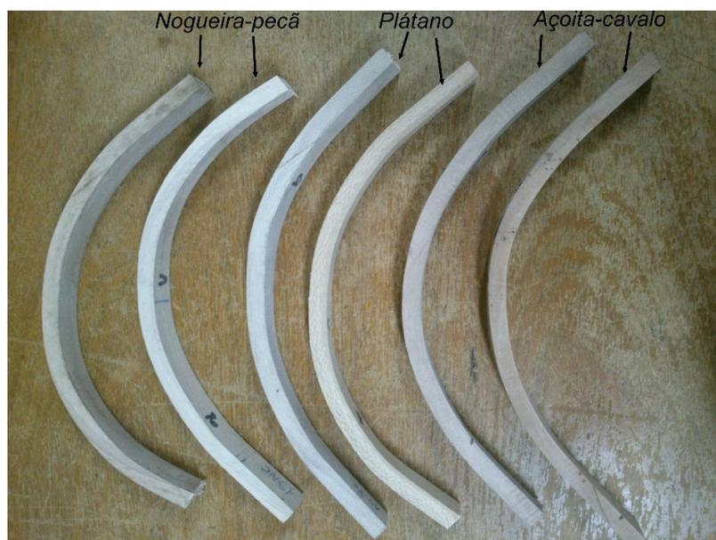
**Figura 16** – Corpos de prova vergados com nota máxima de vergamento. Fonte: O autor.
