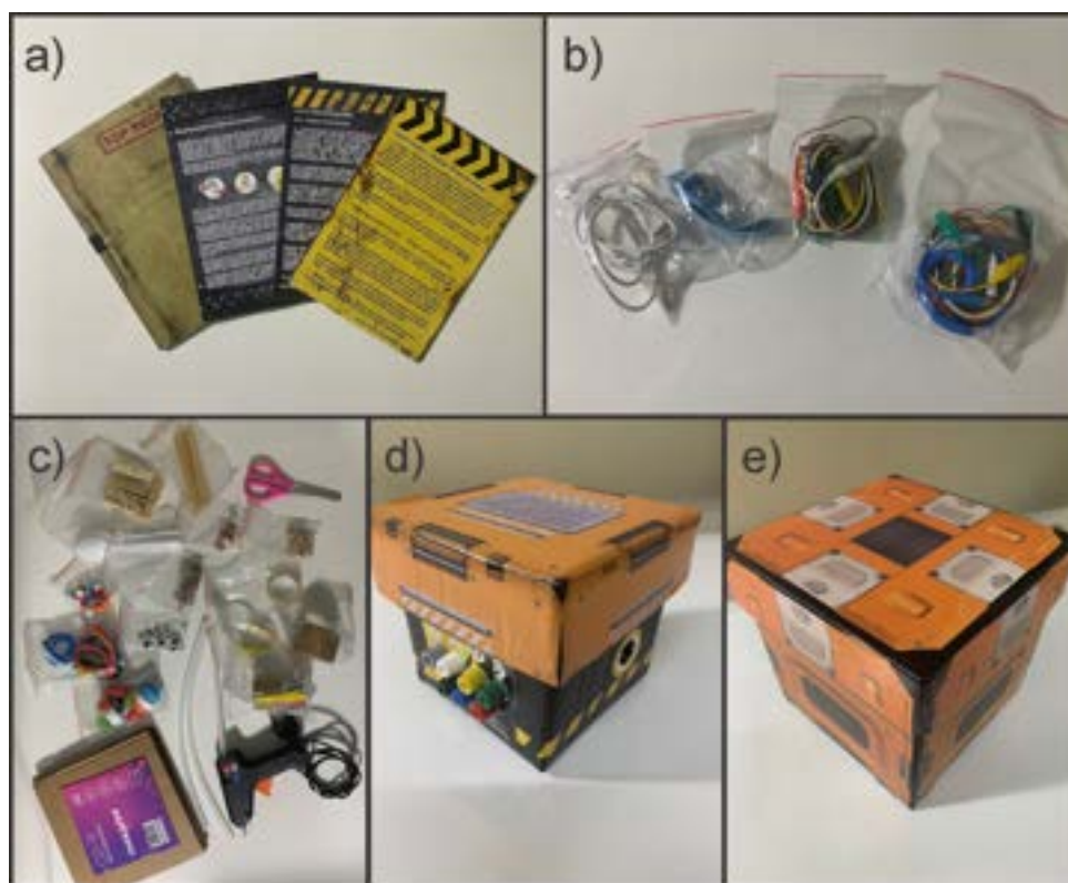
Figura 35 – Kit confeccionado para o experimento remoto: a) material impresso de referência; b) cabos elétricos; c) material de sucata; d) placa prototipadora; e) Caixa. Fonte: Autor
