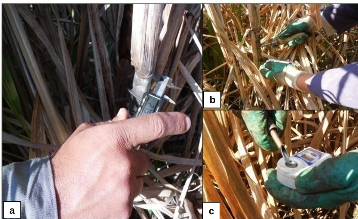
Figura 12 – Determinação do diâmetro do colmo (a), extração do caldo (b) e determinação do °Brix com refratômetro digital portátil (c).
