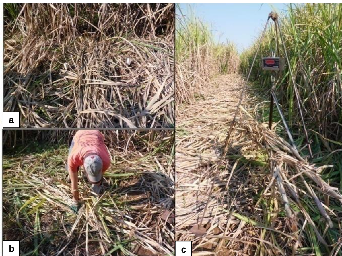
Figura 13 – Colmos cortados e dispostos sobre o ponto de amostragem para avaliação do número e da massa de colmos (a), procedimento de contagem dos colmos (b) e de pesagem dos colmos (c).
