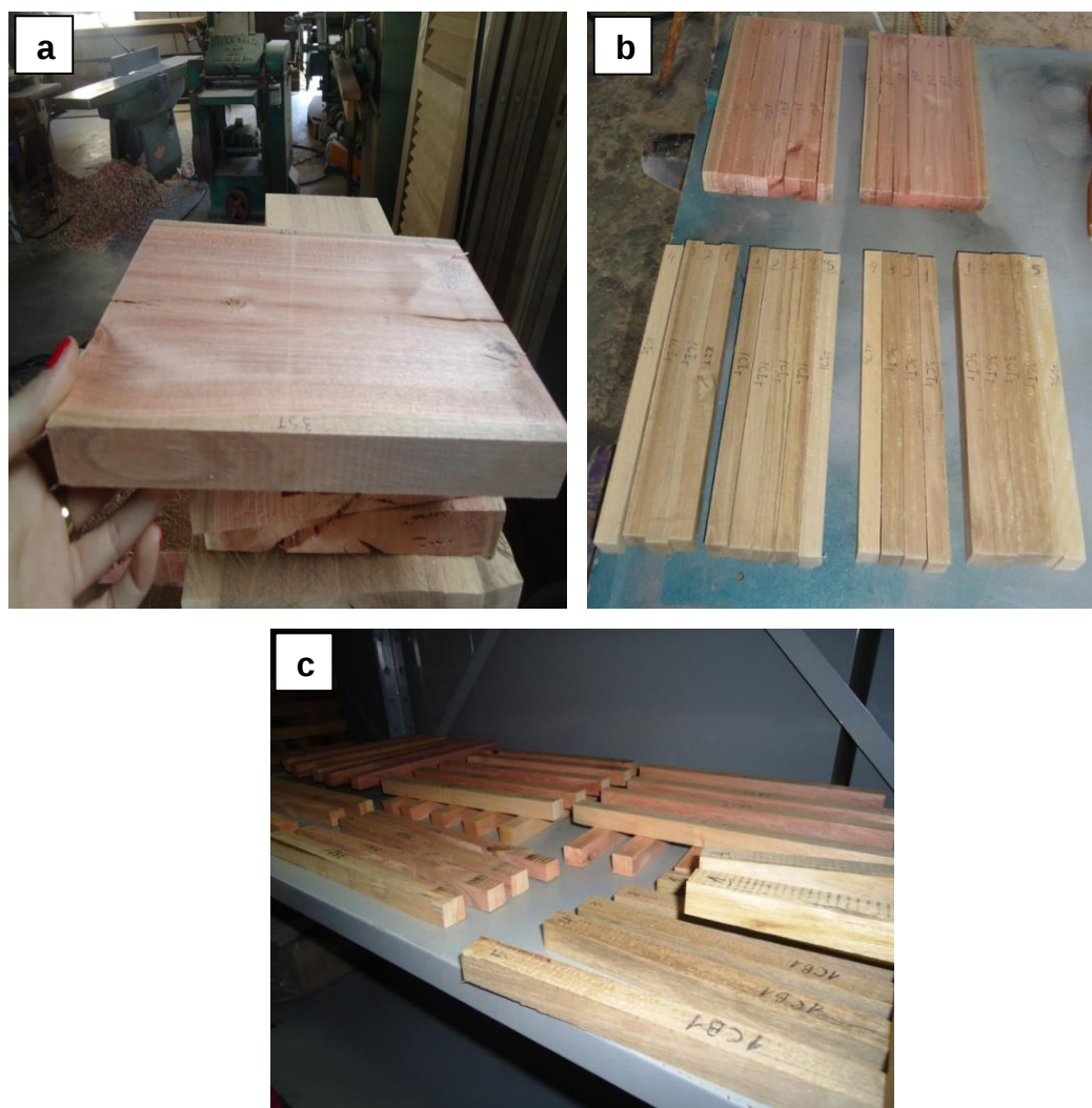
Figura 16 - Obtenção de corpos de prova a partir dos toretes. (a) Prancha central retirada do torete; (b) cp's no sentido medula-casca; (c) Câmara de climatização dos cp's.
