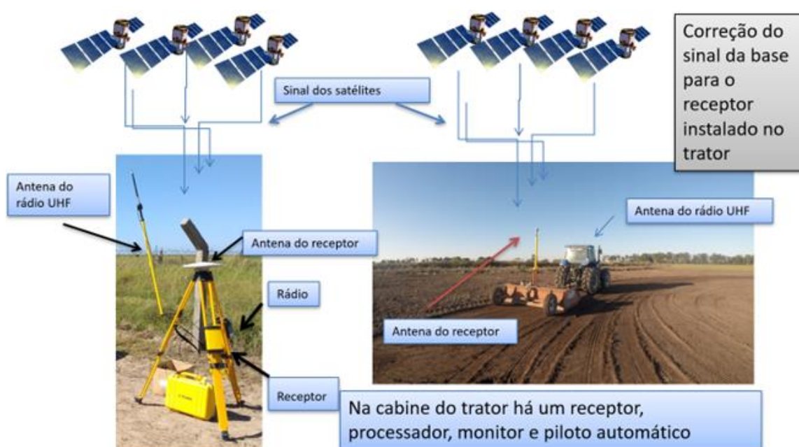
Figura 3: Componentes do sistema GNSS-RTK.
