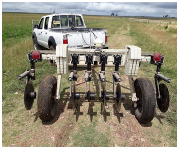
Figura 6: Equipamento Veris utilizado para medir a condutividade elétrica do solo
