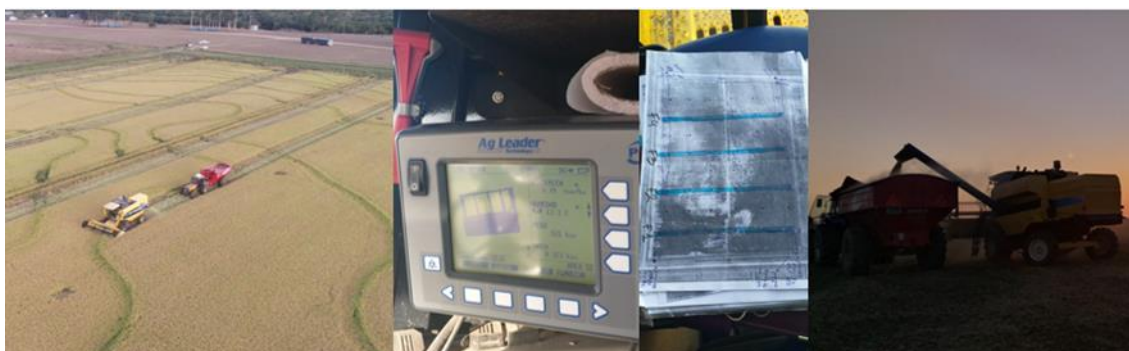
Figura 5: Utilização de sensores de colheita para a geração dos mapas de produtividade, os dados da colhedora foram pesados em um graneleiro com balança afim de aferir os dados.
