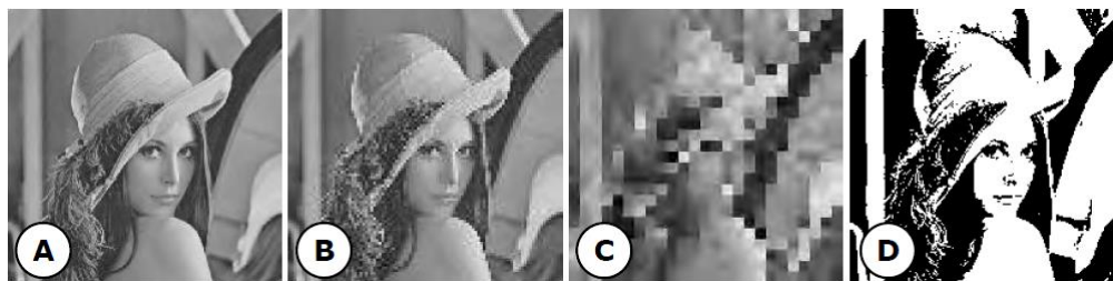
Figura 7– Influência da variação do número de amostras e de níveis de quantização na qualidade de uma imagem digital. (A) 200 x 200 pixels / 256 níveis; (B) 100 x 100 pixels / 256 níveis; (C) 25 x 25 pixels / 256 níveis; (D) 200 x 200 pixels / 2 níveis;
