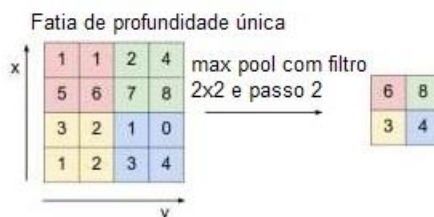
Figura 34 – Exemplo de max pooling de tamanho 2x2 aplicado em uma entrada bidimensional 4x4, onde se propaga apenas o valor mais elevado.
