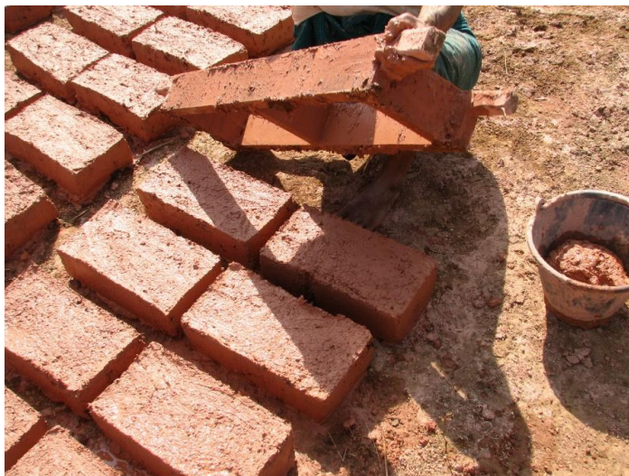
Figura 28: Processo de moldagem de tijolos de adobe.
