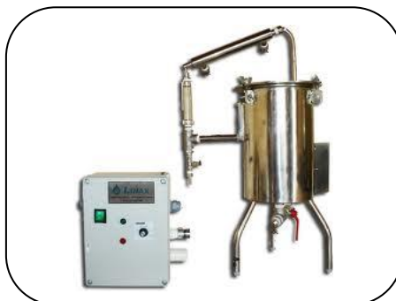
Figura 32. Miniextrator de óleos essenciais de bancada.
