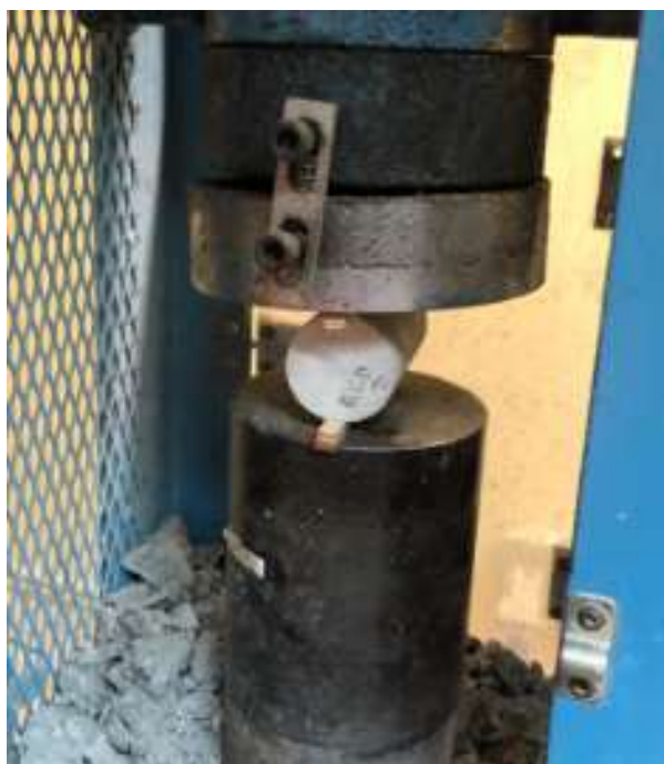
Figura 14 - Corpo de prova na prensa para realização do ensaio de resistência à tração por compressão diametral. Fonte: Autora
