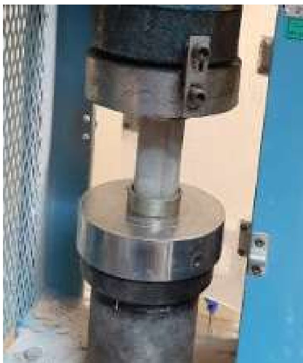
Figura 13 - Corpo de prova na prensa para realização do ensaio de resistência à compressão. Fonte: Autora
