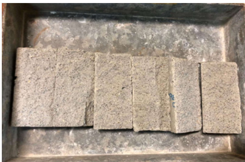
Figura 17 - Corpo de prova rompido diametralmente após a absorção por capilaridade. Fonte: Autora
