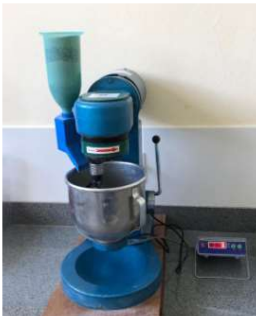
Figura 10 - Argamassadeira automática de movimento planetário Fonte: Autora
