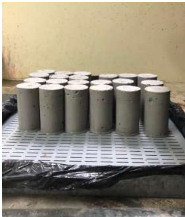
Figura 16 - Corpos de prova em contato com água para o ensaio de absorção Fonte: Autora
