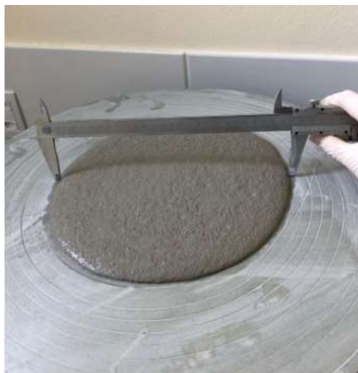
Figura 11 - Verificação do índice de consistência. Fonte: Autora
