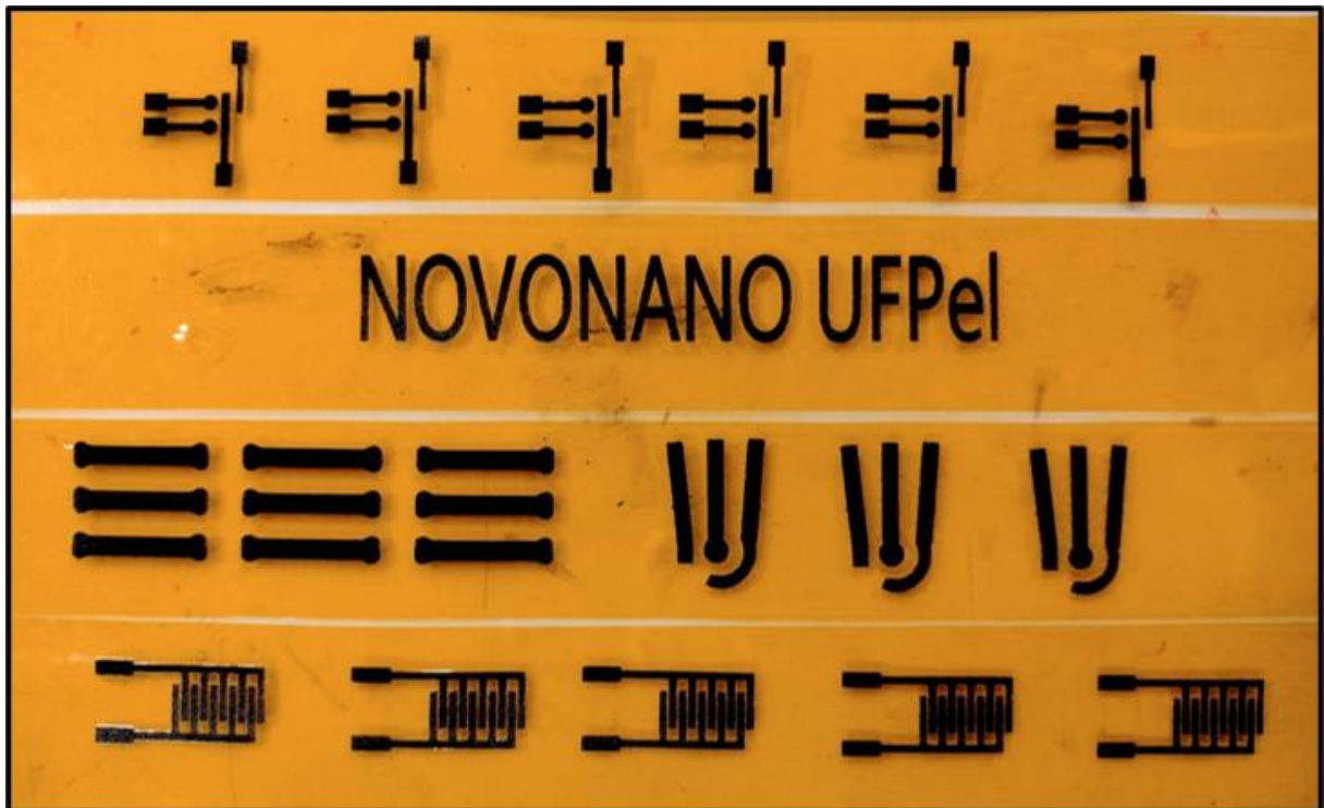
Figura 9: Ilustração de um processo padrão de obtenção de eletrodos de grafeno induzido por laser. Fonte: Imagem própria.
