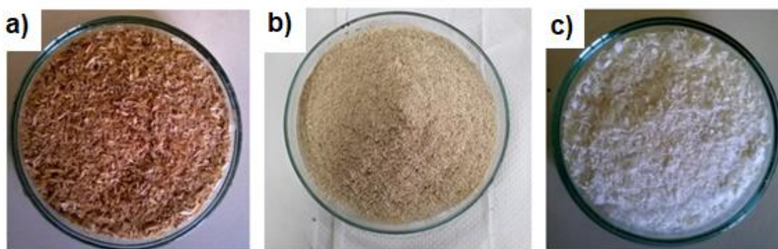
Figura 1 - Imagens de: a) Casca de arroz in natura ; b) Casca de arroz após pré -tratamento; c) celulose após tratamento alcalino e branqueamento.
