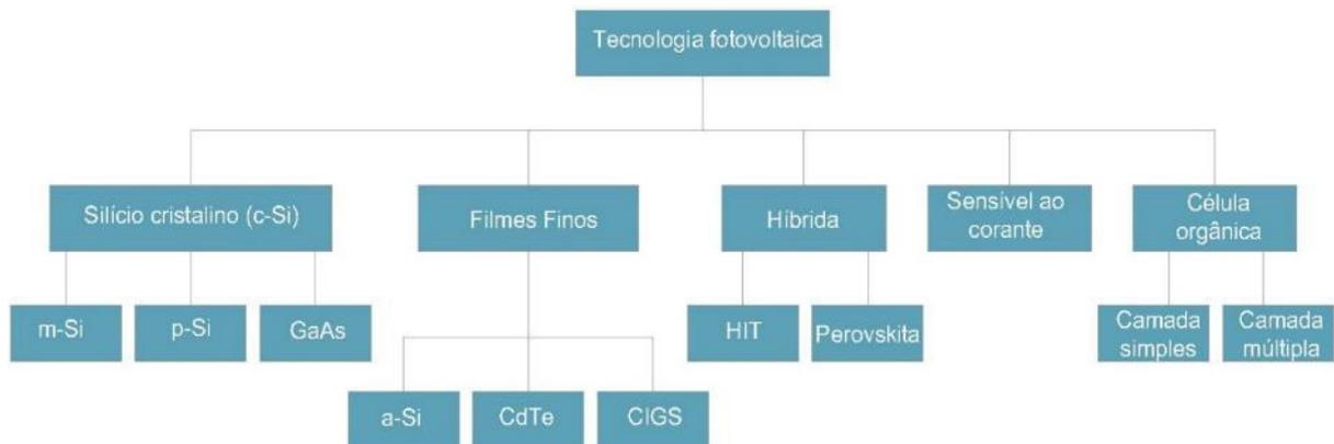
Figura 13 - Diagrama das principais tecnologias de células FV.
