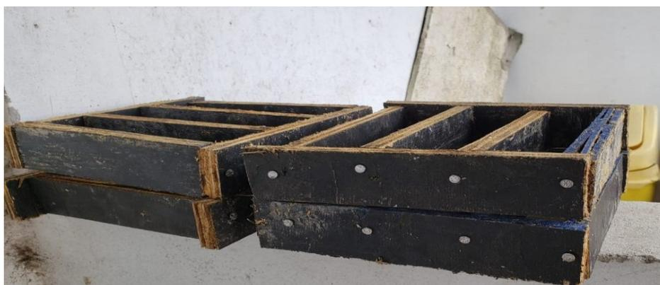
Figura 20: Moldes de madeira de compensado utilizados para a produção dos corpos de provas prismáticos
