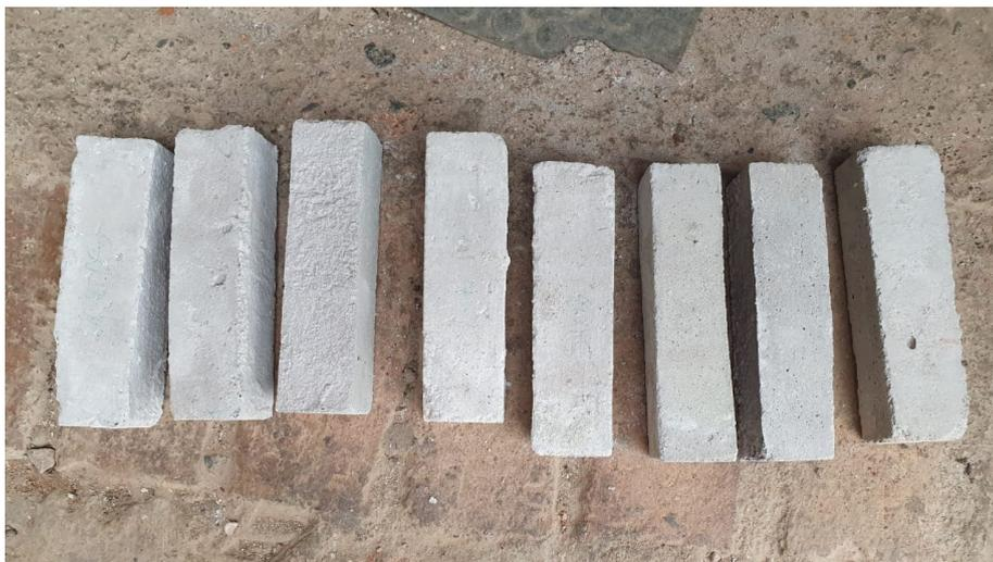
Figura 25: Corpo de prova prismático com 28 dias de cura, pronto para o ensaio de resistência à tração na flexão a três pontos
