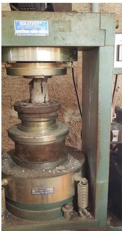
Figura 22: Prensa utilizada no ensaio de ruptura dos corpos de prova cilíndricos
