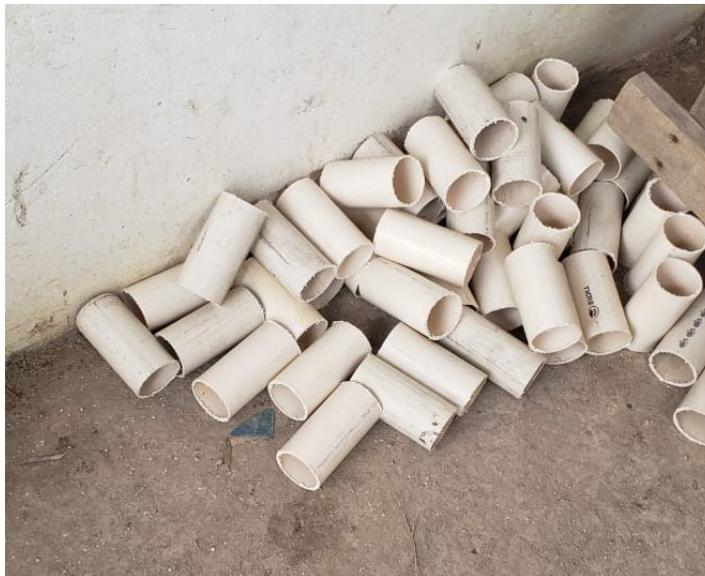
Figura 19: Tubos de PVC utilizados como moldes na produção dos corpos de provas cilíndricos
