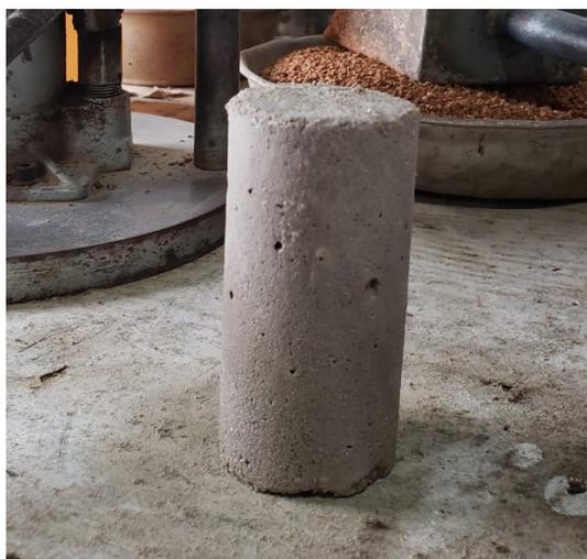
Figura 23: Corpo de prova cilíndrico com 28 dias de cura, pronto para o ensaio de resistência à compressão axial
