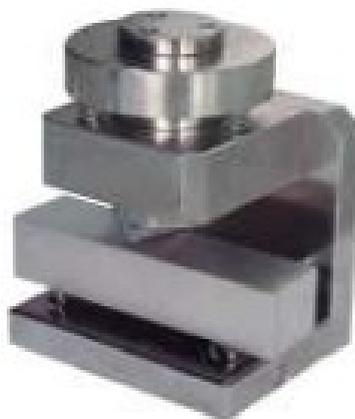
Figura 24: Acessório utilizado no ensaio de ruptura dos corpos de prova prismáticos
