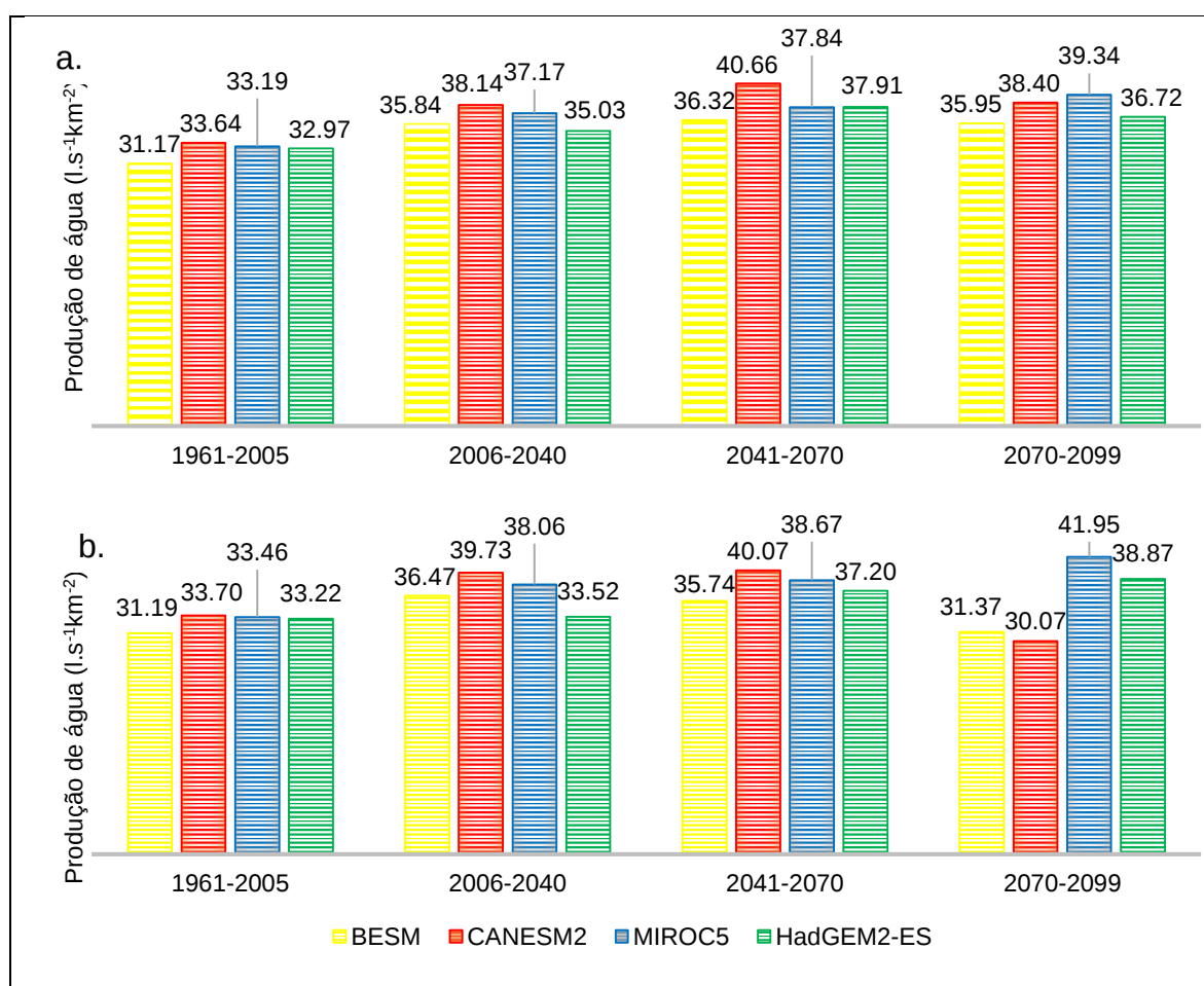
Figura 36 - Produção de água ( \text{l.s}^{-1}.\text{km}^{-2} ) determinada a partir do hidrograma simulado pelo modelo hidrológico SWAT forçado pelos modelos climáticos ETA-BESM, ETA-CANESM2, ETA-MIROC5 e ETA-HADGEM2 para o clima passado (1961-2005) e projeções do clima futuro (2006 a 2099) considerando os RCPs 4.5 (a) e 8.5 (b) para a bacia hidrográfica do arroio Pelotas.
