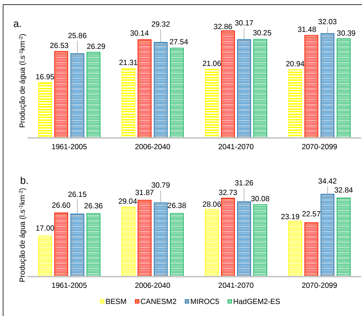
Figura 35 - Produção de água ( \text{l.s}^{-1}.\text{km}^{-2} ) determinada a partir do hidrograma simulado pelo modelo hidrológico SWAT forçado pelos modelos climáticos ETA-BESM, ETA-CANESM2, ETA-MIROC5 e ETA-HADGEM2 para o clima passado (1961-2005) e projeções do clima futuro (2006 a 2099) considerando os RCPs 4.5 (a) e 8.5 (b) para bacia hidrográfica do arroio Fragata.
