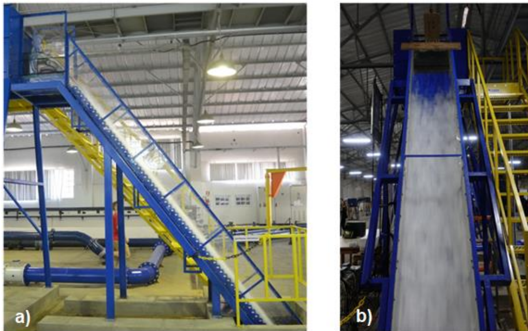
Figura 16 - Modelo LOH II: a) vista lateral e b) vista frontal do vertedouro em degraus.
