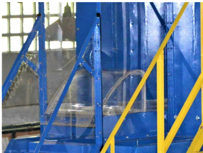
Figura 15 - Imagem aproximada da ogiva tipo Creager do modelo LOH II, construída em acrílico.
