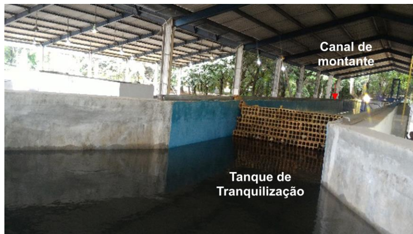
Figura 11 - Tanque de tranquilização do modelo LAHE.
