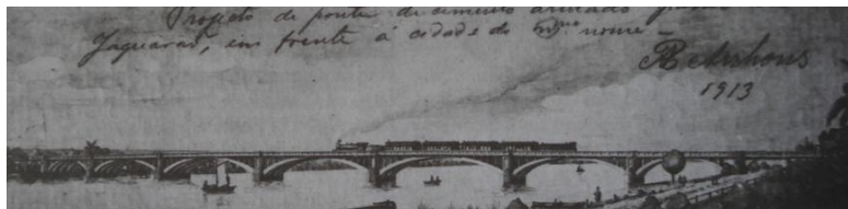
Figura 8. Projeto de ponte de cimento armado para o rio Jaguarão, em frente a cidade de mesmo nome. Desenho do escritório de R. Ahons.
