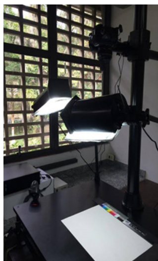
Figura 1 - Estação fotográfica para captura de imagens durante o processo de digitalização das exsicatas. Inclui mesa, hastes de suporte para lâmpadas, haste para a câmera e uma câmera fotográfica, com software próprio para processamento de imagens. Fonte: Projeto REFLORA- www.facebook.com/pg/projetoreflora .
