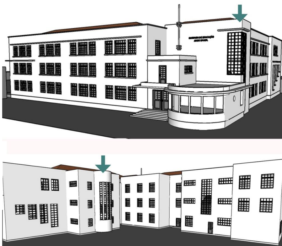
Figura 72 - Volumetria do I.E.E. Assis Brasil, realce nos volumes das escadas. Fonte: Esquema da autora (2019).
