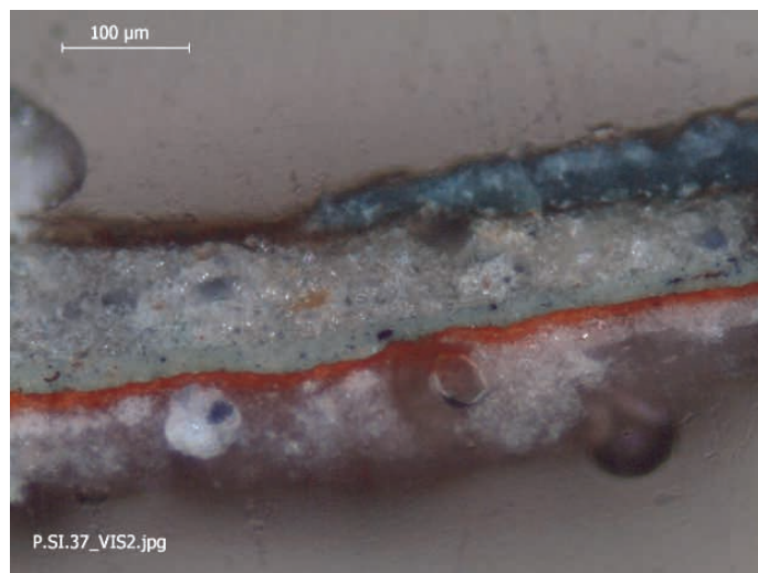
Figura 5 – Corte estratigráfico de amostra da escultura de San Pedro do Museu Diocesano de San Ignacio Guazú.
