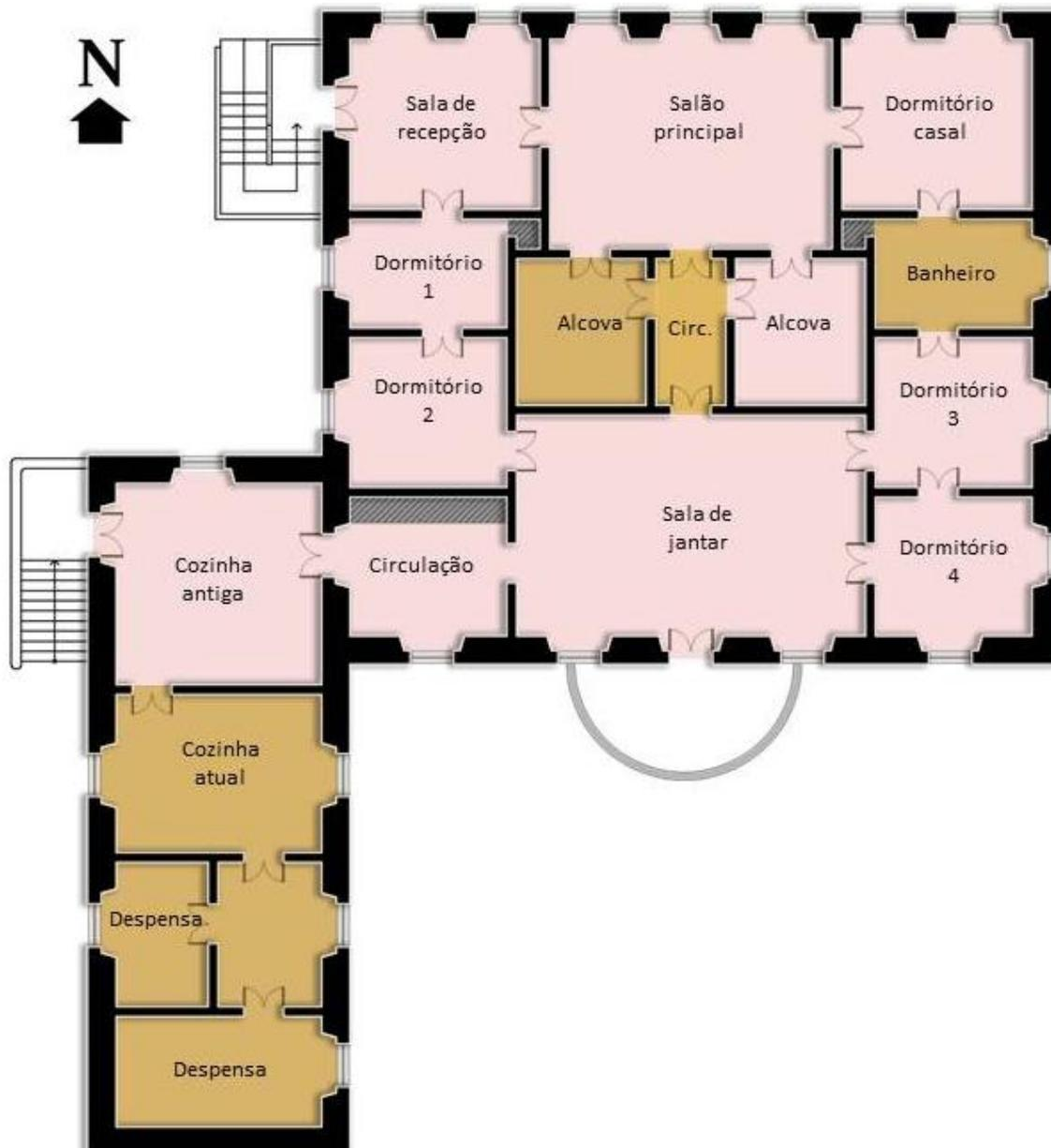
Figura 64: Planta baixa identificando as peças segundo o tratamento das paredes.
