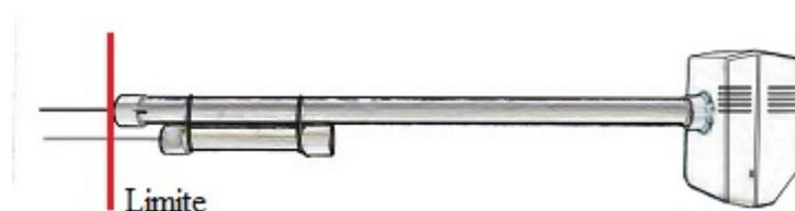
Figura 15 – Limite de inserção no composto - Fonte: Elaborada pelo autor
