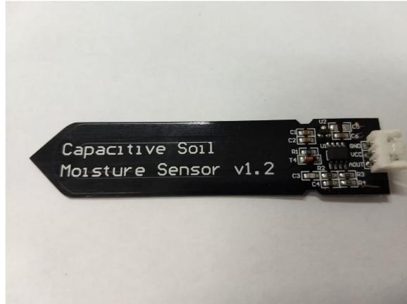
Figura 12 – Sensor capacitivo - Fonte: Elaborada pelo autor
