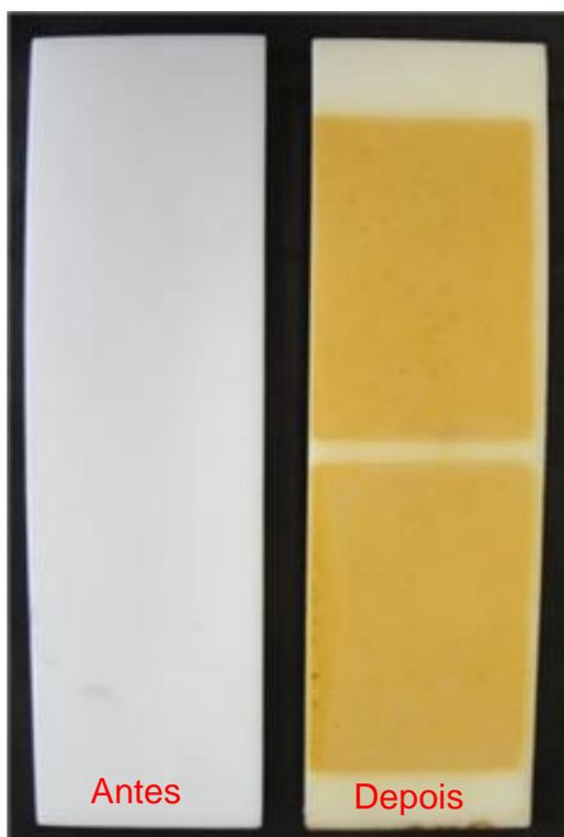
Figura 72 - Massa de reintegração volumétrica resina epóxi e microesfera de vidro (RE MV), antes e depois do ensaio de envelhecimento artificial.
