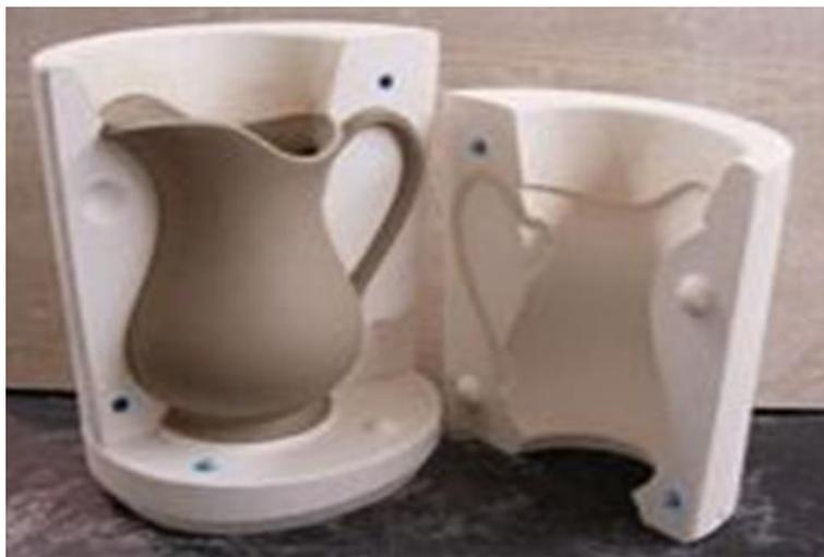
Figura 7 - Desmonte do molde de gesso com três tasselos.
