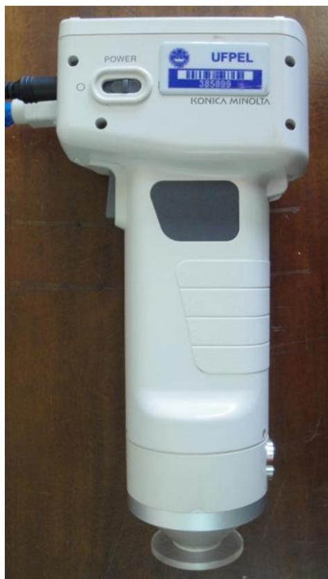
Figura 58 - Colorímetro CR-400/410 da marca Konica Minolta, utilizado no desenvolvimento do trabalho.
