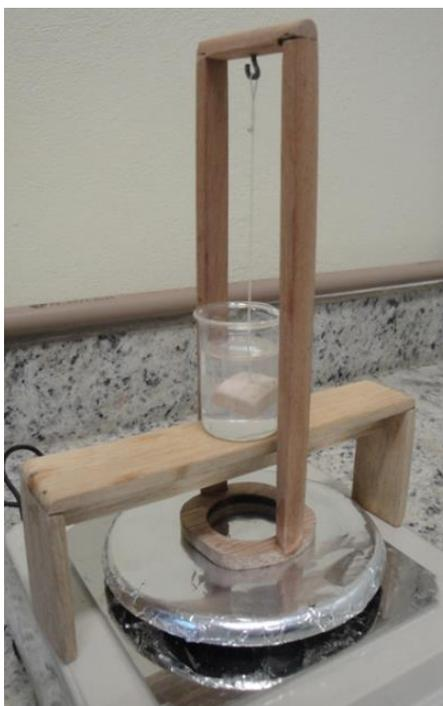
Figura 54 - Teste de absorção de água e porosidade aparente dos cps da massa cerâmica comercial testada para uso como substrato cerâmico experimental.
