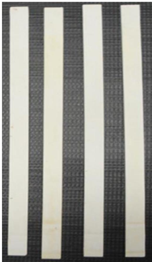
Figura 68 - Massa RP MP depois da exposição na câmara de envelhecimento.
