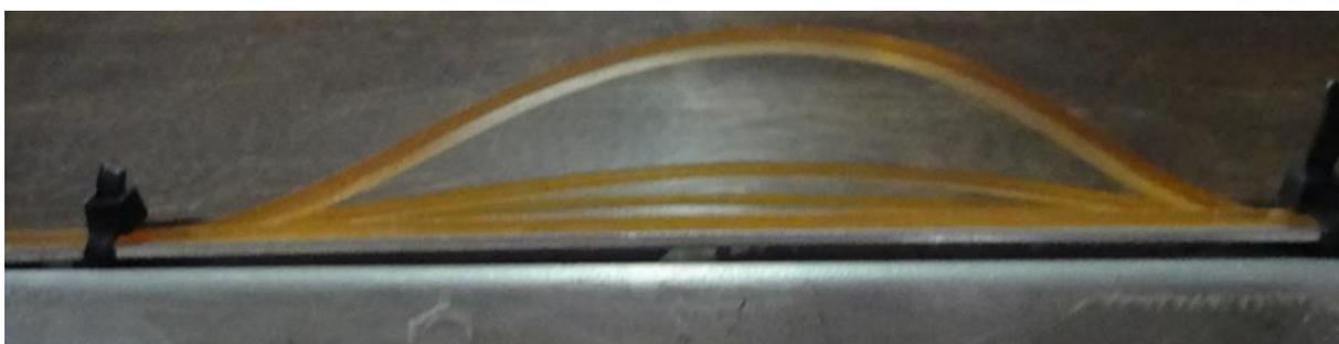
Figura 69 - Massa de reintegração volumétrica RE P, com curvatura, nos 30 primeiros dias de ensaio de envelhecimento acelerado artificial.
