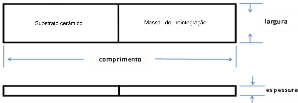
Figura 65 - Corpo de prova de borracha de silicone composto pela massa de reintegração volumétrica de melhor desempenho e pelo substrato cerâmico experimental.
