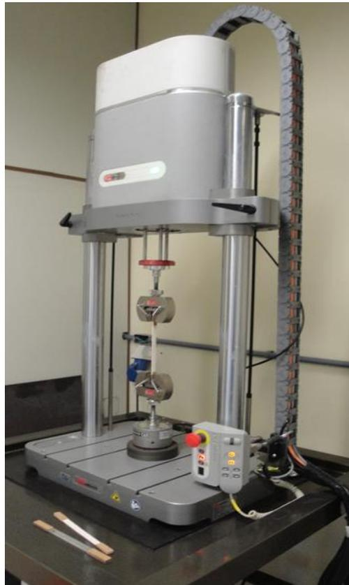
Figura 62 - Máquina de ensaio universal utilizada no ensaio de tração das massas poliméricas.
