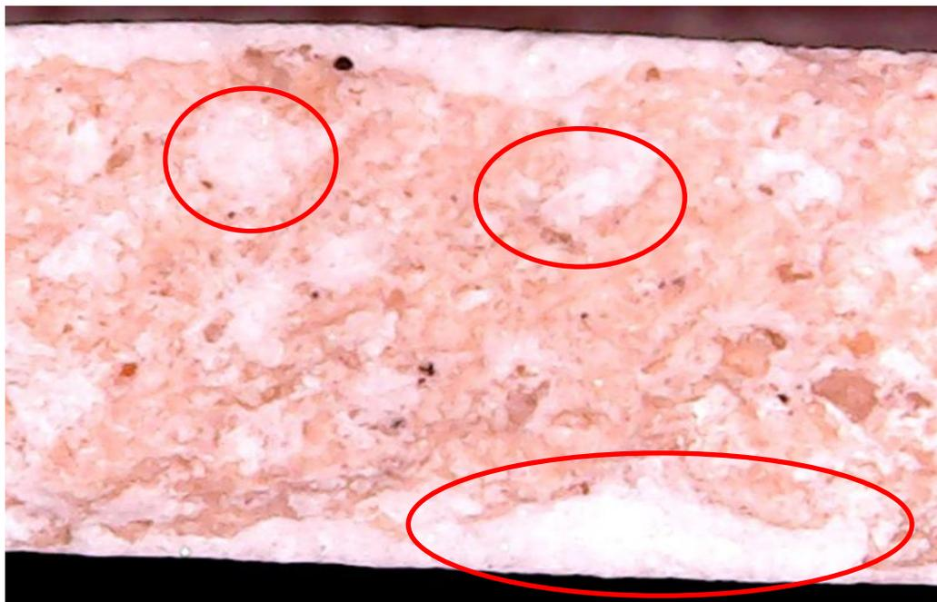
Figura 83 - Face de junção do substrato cerâmico depois do envelhecimento acelerado artificial com fragmentos de massas RP MP.
