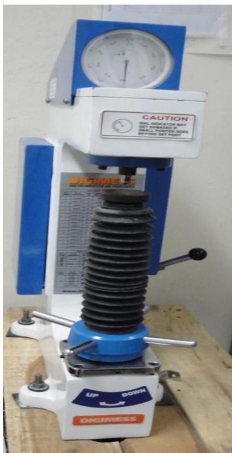
Figura 60 - Durômetro de bancada Rockwell, da marca Digimes, utilizado no ensaio de dureza das massas de reintegração volumétrica. ,
