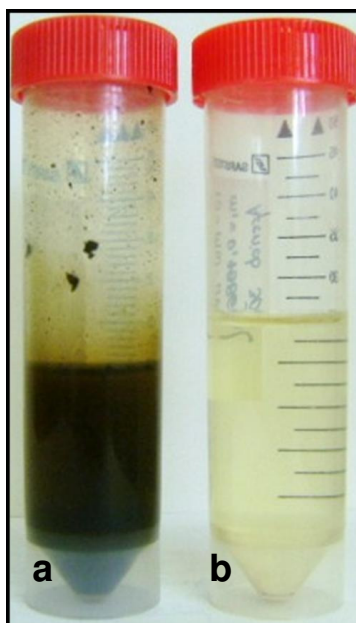
Figura 11 - Aspecto dos digeridos após a decomposição da alga Desmarestia anceps com soluções de \text{HNO}_3 1 \text{ mol l}^{-1} (a) decomposição por MW- \text{O}_2 -AD e (b) decomposição por MW-UV-AD.
