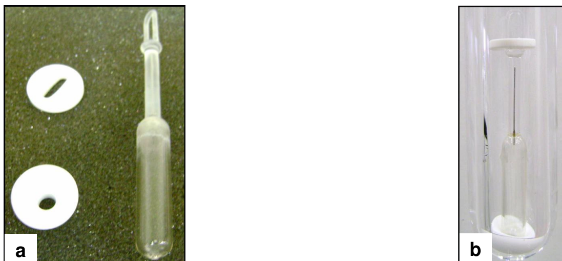
Figura 3 - (a) Lâmpada de Cd de baixa pressão e os dispositivos de PTFE utilizados para posicionar a lâmpada de emissão UV no frasco de decomposição por MW-UV-AD e (b) frasco de quartzo do forno micro-ondas com a lâmpada de Cd para a emissão de radiação ultravioleta.
