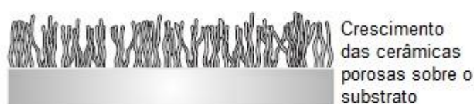
Figura 4 - Demonstração esquemática do crescimento das estruturas porosas sobre o substrato durante tratamento térmico.
