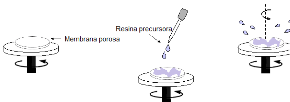
Figura 3 - Demonstração esquemática do processo de impregnação do substrato poroso utilizando a técnica de Spin coating .
